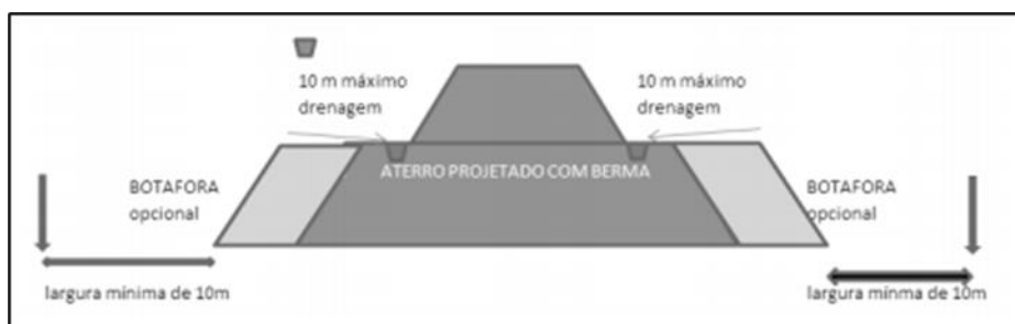
Figura 4.36. Bota-fora em segmentos da terraplenagem de projeto com aterros com altura máxima entre 8 e 16 metros
