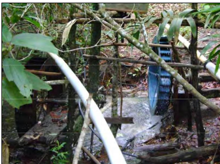
Figura 6.3.229. Captação de Água do Córrego São Bento com o Uso de Roda d'água, em 2009
